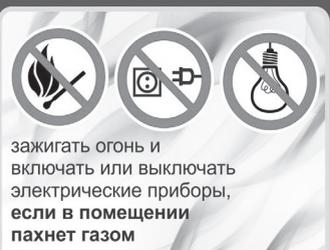
зажигать огонь и включать или выключать электрические приборы, если в помещении пахнет газом
