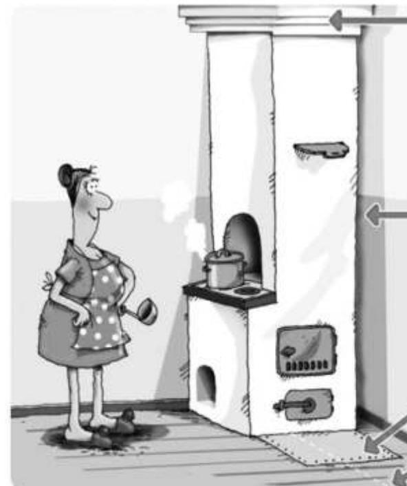
Разделка – утолщение в кладке печи и дымохода, создающее малотеплопроводимый слой между нагретой частью печи и легковоспламеняющимися элементами, препятствующее загоранию конструкций, прилегающих к печи.
