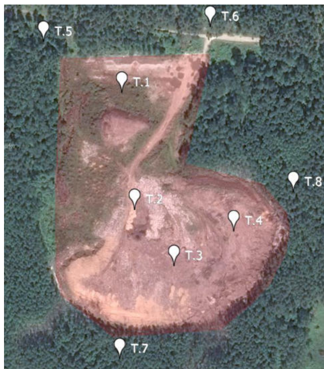
Рисунок 3.10.1 – Схема отбора проб почвы на объекте Т.1–Т.4 – подстилающие слои под телом свалки; Т.5–Т.8 – в границах ориентировочной СЗЗ
